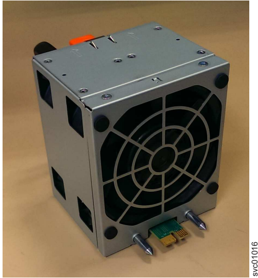
Figure 81. Fan module orientation
